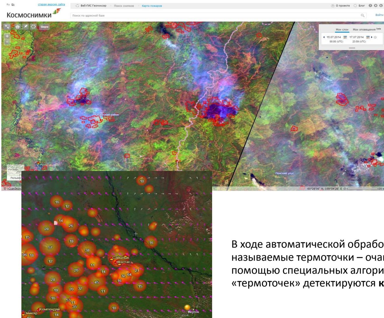
Мониторинг пожарной обстановки по спутниковым данным позволяет оперативно получать достоверную информацию о пожарах по обширной территории. Данные с полярно-орбитальных метеорологических спутников Terra, Aqua и NPP принимаются на собственную сеть станций «СКАНЭКС», которая охватывает всю страну.
